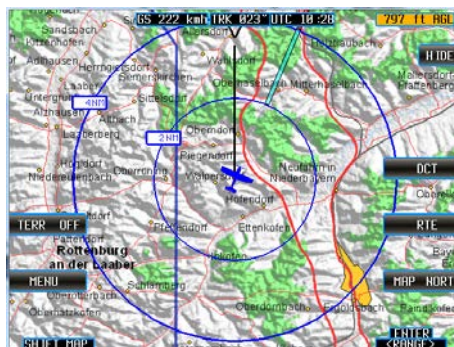
Abb. 26: "ALT AGL", AGL zwischen 500...1000 ft (150...300 m)
