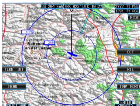
Abb. 28: "ALT M+A", AGL + MSL angezeigt
